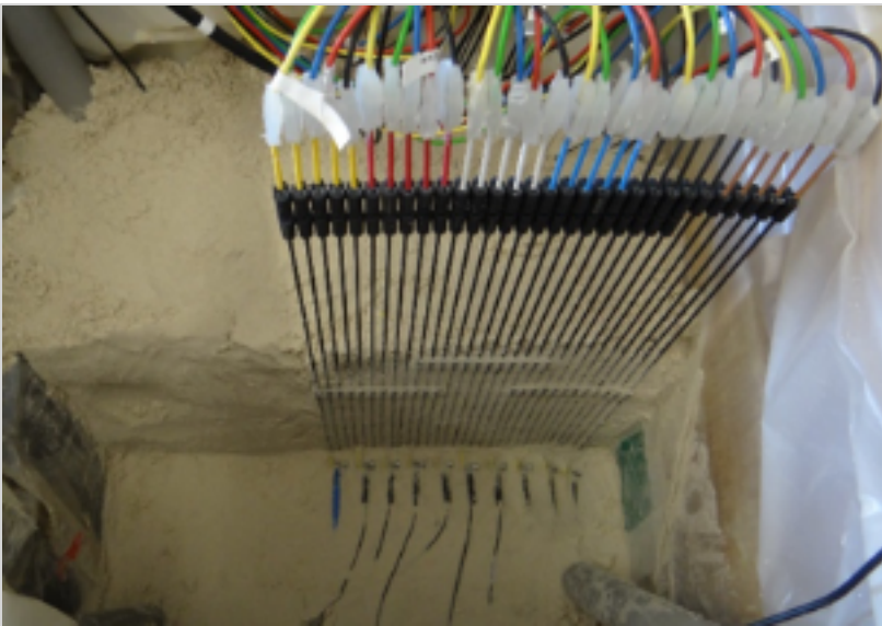
Électrodes mesurant des différences de potentiels électriques dans des expériences sismo-électriques réalisées dans un sable partiellement saturé en eau (Holzhauer et al., 2015).
